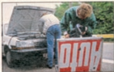
Das Meßgerät braucht natürlich „Salt“. Deshalb wird es an die Batterie angeklemt
