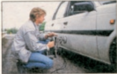
Mit starken Saugnapfen wird das Meßgerät an der Karosserie des Carina II befestigt
