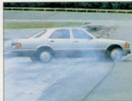
Gleiche Situation wie auf dem Foto oben, nur wurde im 300 SE das ABS abgeschaltet. Ergebnis: Er schleudert
