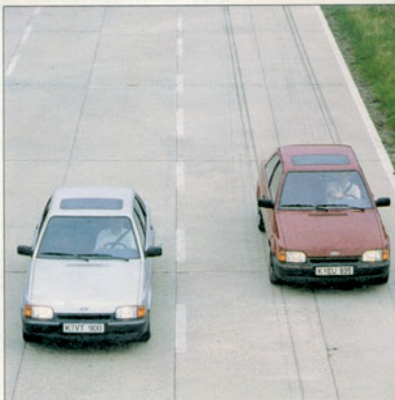
Dieses Foto zeigt es ganz deutlich: Der rote Ford Escort ohne SCS steht nach einer Vollbremsung (an den Brems Spuren zu sehen) schon deutlich früher als der Escort mit SCS
