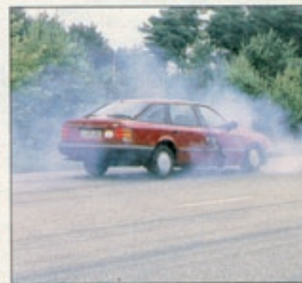
Vollbremsung ohne ABS: Die Räder blockieren und qualmen. Nach dem Nothalt sind die Reifen kaputt
