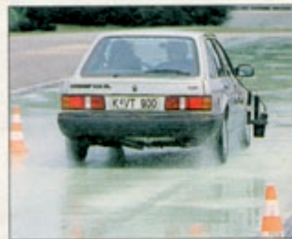
Der Escort bleibt bei einer Vollbremsung mit SCS (mechanischem ABS) auch auf nasser Straße lenkbar
