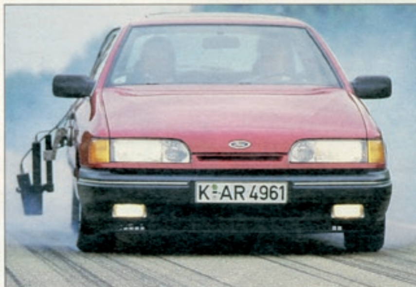
Um für die beiden Escort vergleichbare Bedingungen zu schaffen, mußten sie auf identischen Reifen stehen. Das häufige Wechseln artete in harte Knochenarbeit aus (Foto oben). Bremswegmessungen mit einem Metermaß sind viel zu ungenau. Auto Bild setzte dafür teure elektronische Meßgeräte ein, die den Weg auf den Millimeter genau messen können
