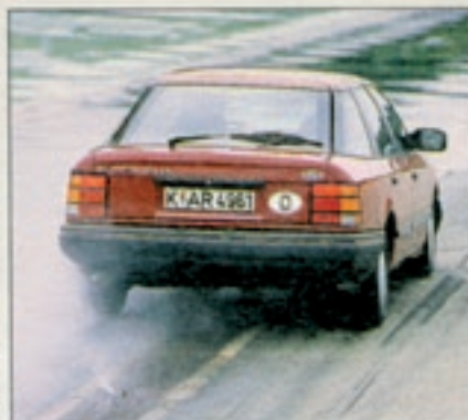
Rechts trockene Fahrbahn, links eine glitschig nasse Fahrbahn. Mit ABS bleibt das Auto beim Bremsen in der Spur
