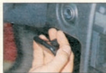
Dieser Hebel ist kein Choke, sondern ein Kaltstartbeschleuniger. Wird er gezogen, wird die Leerlaufdrehzahl während der Warmlaufphase erhöht
