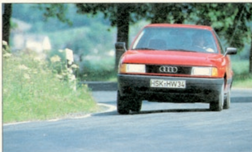
In schnell gefahrenen Kurven schiebt der Audi 80 Diesel stark über die eingeschlagenen Vorderräder. Grund: Der schwere Motor macht ihn kopflastig
