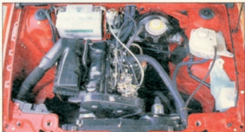
Der Dieselmotor aus dem Audi 80 ist ein alter Bekannter. Er wird von VW gebaut und ist auch im VW Golf/Jetta und VW Passat zu haben
