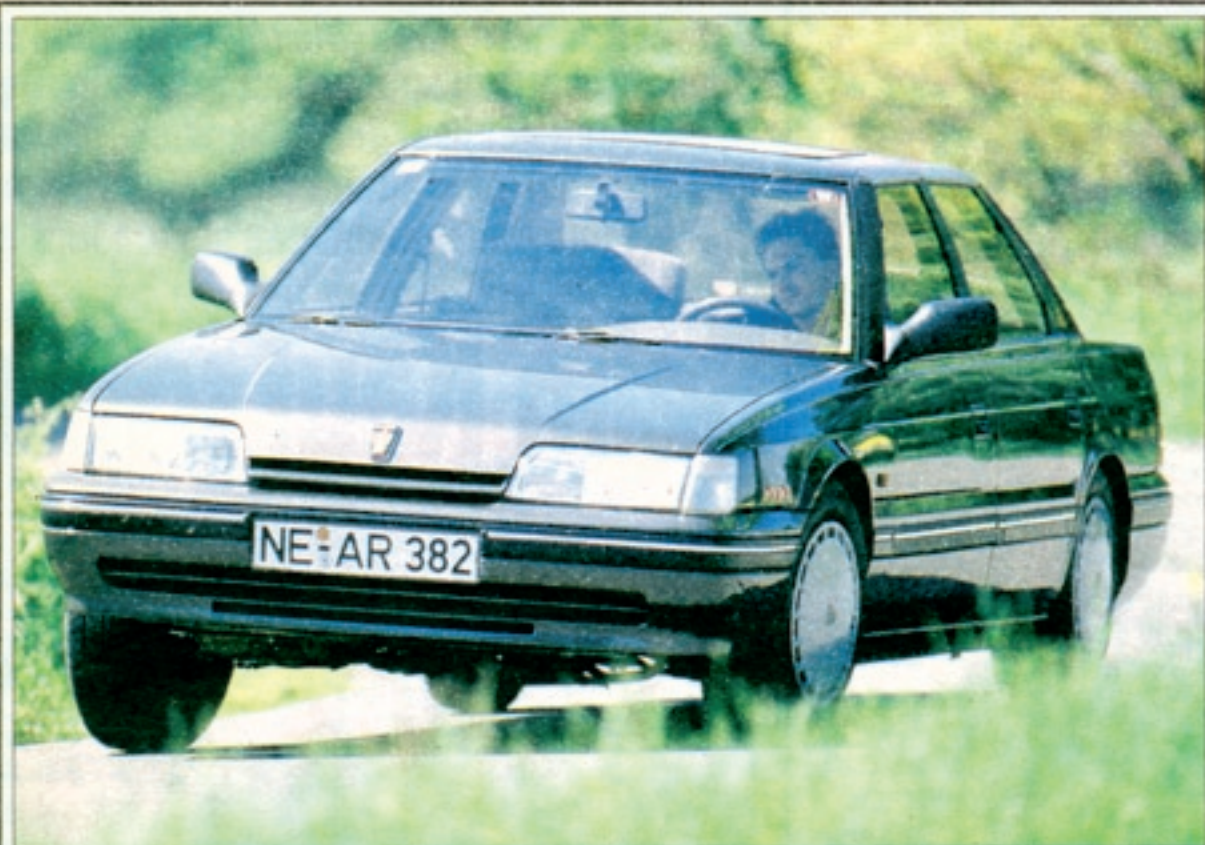
Im Fahrverhalten sammelt der Fronttriebler Minuspunkte: Bei schneller Kurvenfahrt trampelt das jeweils unbelastete Antriebsrad. Diese Unart hat auch der ähnliche Honda Legend. Doch in der reinen Fahrleistung schlägt der Rover 825i den Ford Scorpio 2.9i Ghia
