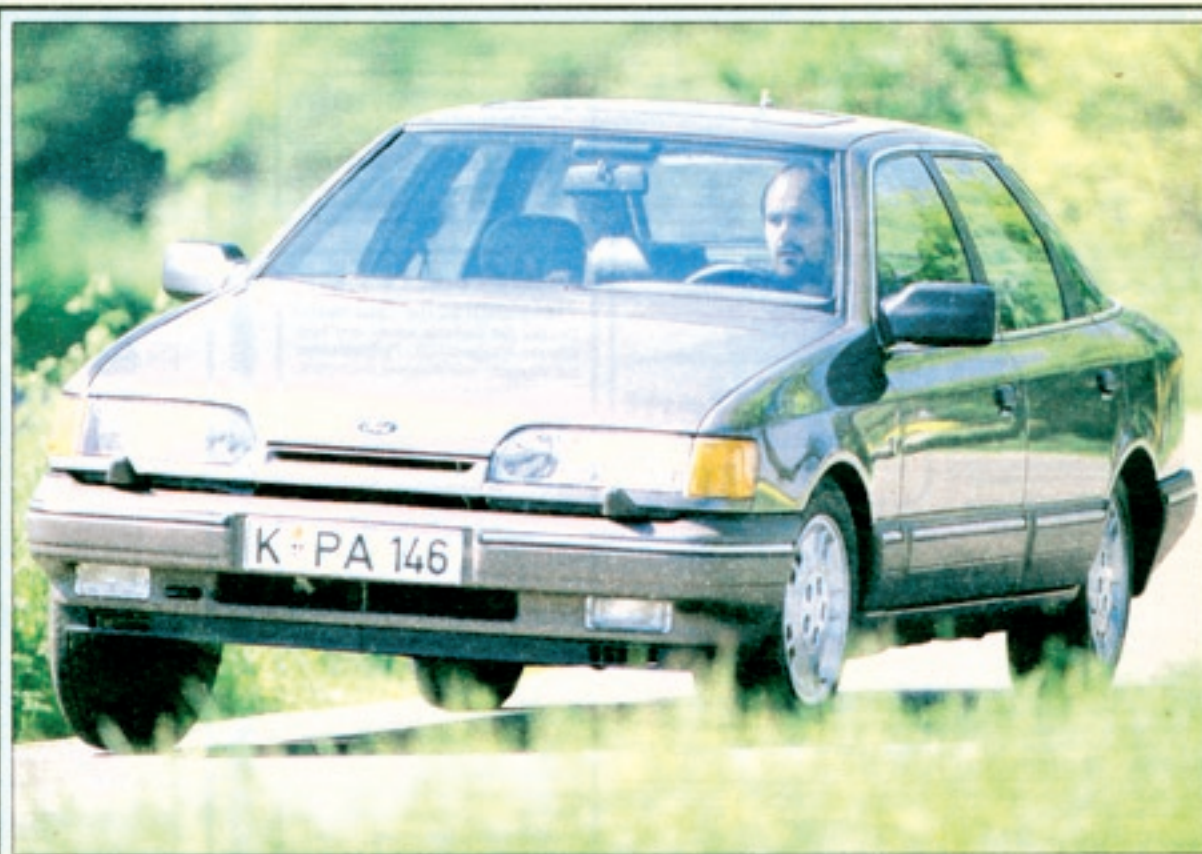
Der heckgetriebene Ford Scorpio 2.9i glänzt mit überdurchschnittlichem Komfort. Schnelle, enge Kurven mag er nicht. Bei Nässe muß man mit dem Gaspedal vorsichtig sein, sonst kommt das Heck herum und will mit der präzisen Servolenkung abgefangen werden
