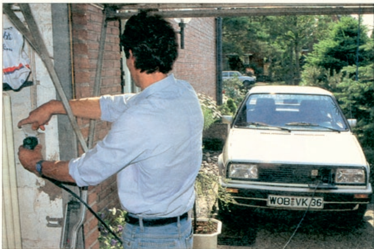
Einfach an die Steckdose anschließen und „auftanken“: Der Jetta Citystromer ist nach acht Stunden wieder voll geladen
