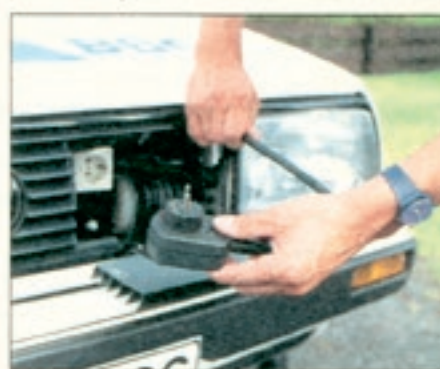
Klappe auf, Stecker raus – die Kabelrolle hinter dem Frontgrill mißt drei Meter und wickelt sich selbsttätig auf
