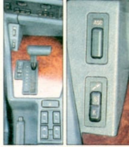
Automatik ist seriennäßig. Rechts: Kippschalter für Dämpfkraftverstellung
