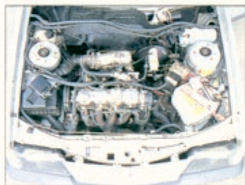
In der Kat-Version leistet der Zweilitermotor 115 PS. Ohne Kat 130 PS. Der quer eingebauter Vierzylinder ist von allen Seiten gut zugänglich – wichtig für Servicearbeiten
