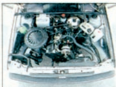
Der 1,6-Liter-VW-Motor entwickelt ein höheres Drehmoment als die Opel- oder Ford-Maschine, und das schon bei niedriger Drehzahl
