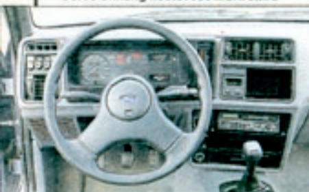
Alle wichtigen Schalter befinden sich im Sierra an der Lenksäule. Blinker/Lichtkappe links, Scheibenwischer rechts, dahinter Stand-/Fahrlicht
