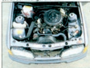
Im Leerlauf dreht die Ford-Maschine unruhig und schüttelt den Wagen. Die Zündkabel werden vom Auspuffkrümmer stark erhitzt
