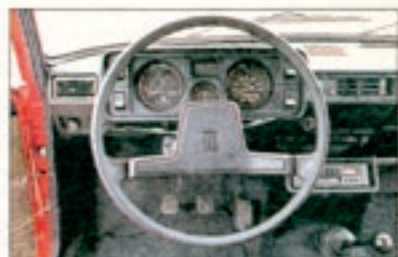
Lada-Cockpit: geprägt durch ein riesiges Lenkrad und spartanische Instrumentierung. Der Fußraum ist viel zu kurz. Die Türen öffnen nicht weit genug. Die Sitzverstellung ist unpraktisch. Dafür wird fünf Passagieren eine Menge Platz geboten
