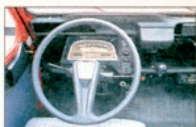
Enten-Cockpit: Alles anders als anderswo. Nur das Nötigste wird angezeigt. Der Schalthebel ragt rechts aus der Verkleidung. Alle Schalter sind gekonnt verstreut – nur für Döschwo-Insider kein Problem. Der Citroën 2 CV ist reine Einstellungssache
