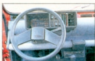
Seat-Cockpit: Die einzigen Instrumente sind der Tacho und die Benzinuhr. Die Innenraum-Verkleidung ist dürrig. Viel Blech. Dafür ist der Winzling sehr übersichtlich. Praktisch: die Heckklappe. Sie kennzeichnet das „moderne“ Auto
