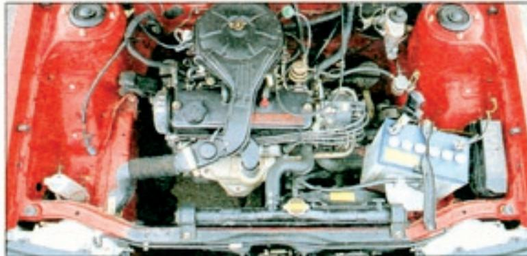
Die Zwölfventilmaschine wird von einem Vergaser mit Choke gespeist, läuft kultiviert und dreht 6200 Touren. Schon bei niedrigen Drehzahlen ist sie ausreichend kräftig
