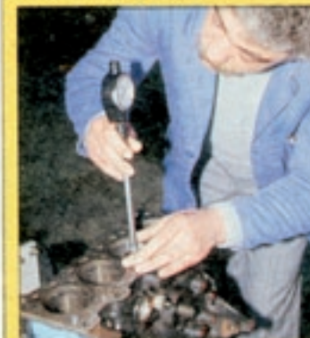
Die Messungen ergeben: Die Zylinder haben während des Dauertests gelitten
