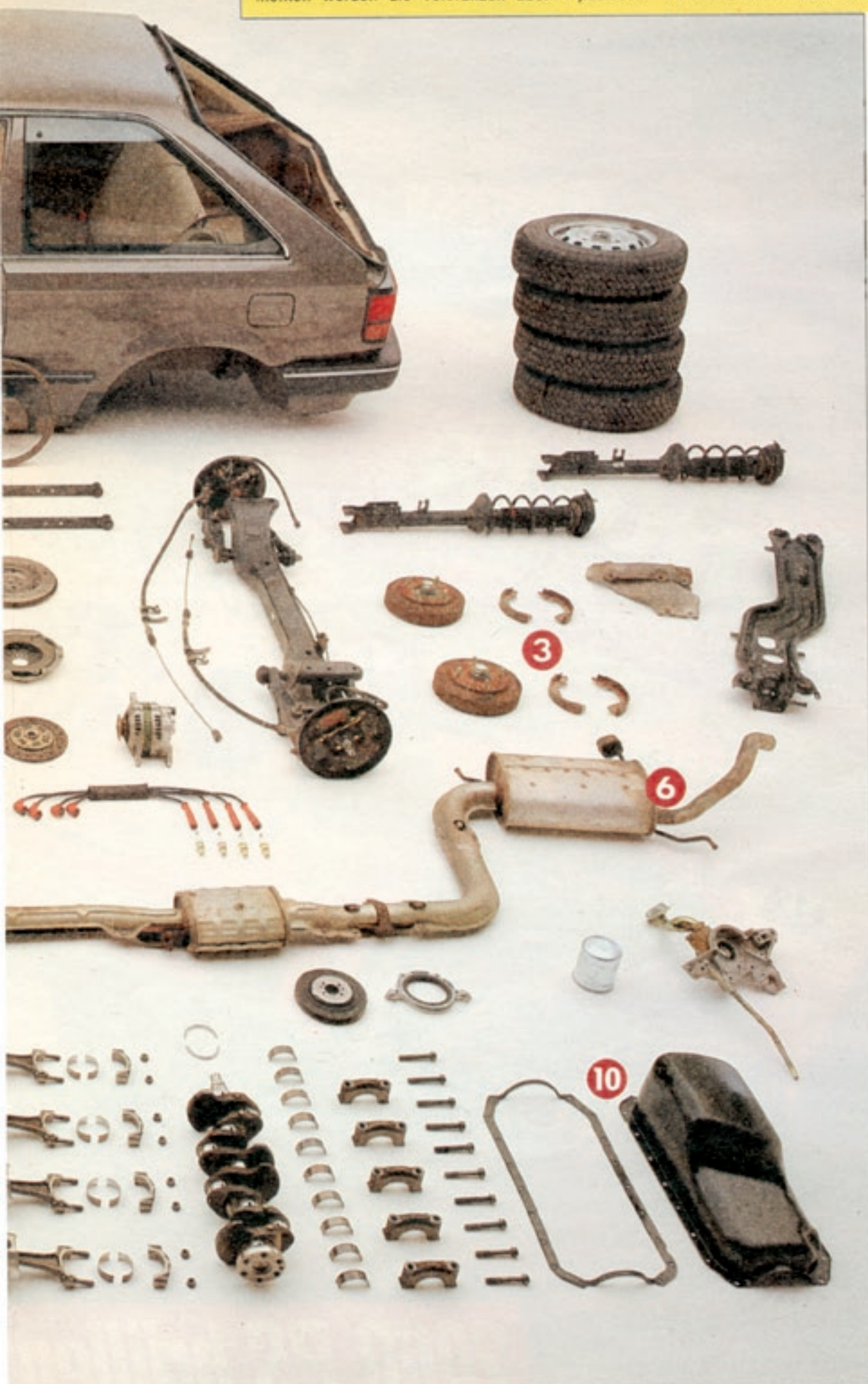
Das Auto Bild-Team beim Vermessen der fünf Kurbelwellenlager. Sie zeigen keine Verschleißerscheinungen
