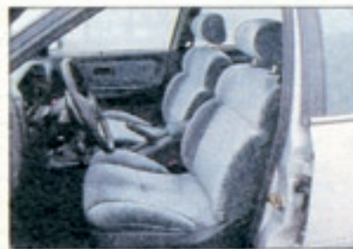
Die Vordersitze sind in der Höhe verstellbar. Das geht etwas umständlich mit einer Kurbel unter dem Sitz
