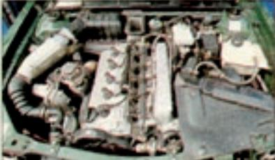
Der Fünfzylinder mit Turbo, Ladeluftkühler und Aggregaten füllt den Motorraum voll aus
