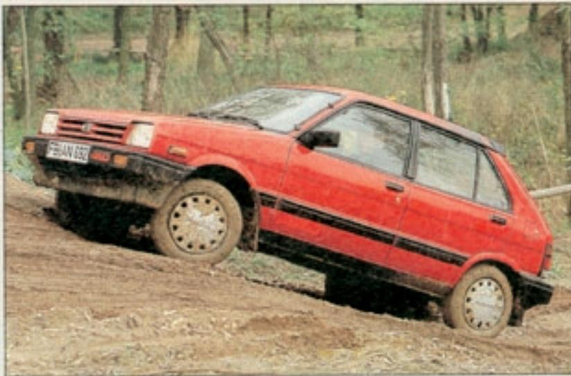
Der neue Super-Justy 1200 Allrad hat sich äußerlich kaum verändert. Der Kühlergrill wurde modernisiert und in Wagenfarbe lackiert. Zusätzlich hat Subaru das Wagendach hinten um einige Zentimeter erhöht, damit die Passagiere im Fond mehr Kopffreiheit haben.
