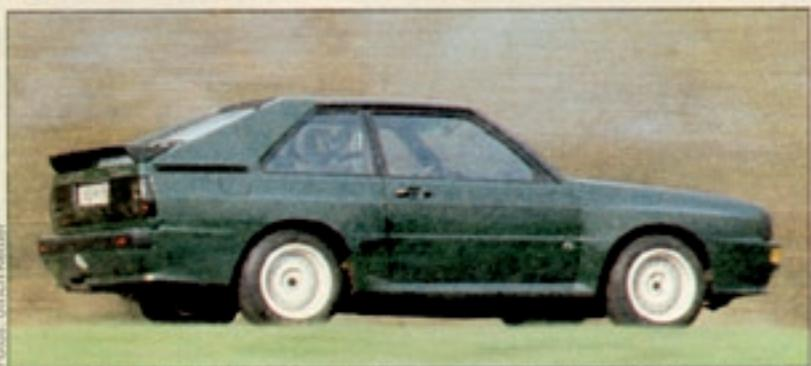
Der von Audi für den Rallye-Sport entwickelte Sport quattro hat Kraft im Überfluss. In nur fünf Sekunden sprintet er von 0 auf 100 km/h. Die Höchstgeschwindigkeit beträgt 252 km/h.
