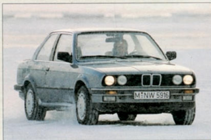
Schwellerleisten, verbreiterte Radhäuser und erhöhte Bodenfreiheit unterscheiden den 325iX äußerlich vom 325i mit Heckantrieb. Zu den Stärken des Allradlers zählen ohne Zweifel das gutmütige Fahrverhalten und der kraftvolle 171-PS-Reihensechszyylinder.
