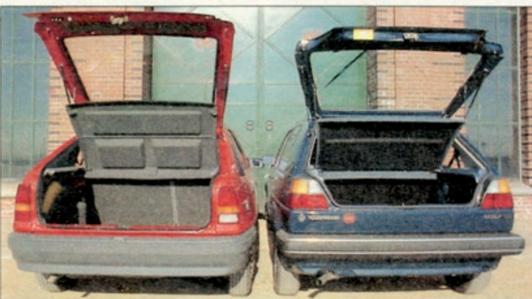
Das vollständig verkleidete Gepäckabteil des Opel Kadett ist durch die weit nach unten öffnende Klappe sehr gut zu beladen. Beim Golf-Kofferraum mißfallen die hohe Ladekante und die nackten Blechpartien
