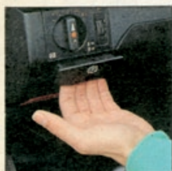
Die Mercedes-Feststellbremse (per Fuß) wird über diesen Hebel gelöst
