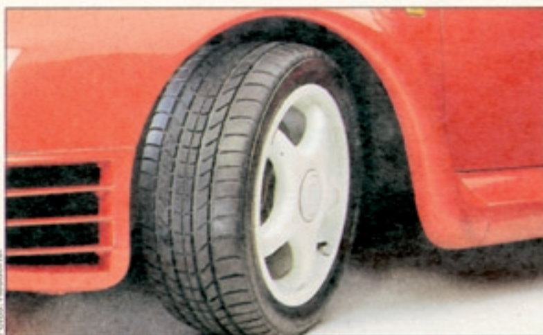
Das ist der erste Serienreifen der Welt, der eine Geschwindigkeit von mehr als 300 km/h verträgt: Der Bridgestone RE 71 wurde eigens für den Porsche 959 entwickelt
