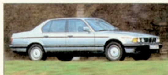
Die Linie des BMW ist modern und windschlüpfig – der cW-Wert liegt bei 0,32
