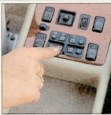
Gegen Aufpreis lassen sich die Mercedes-Sitze elektrisch verstellen. Die Bedienung des Bord-Computers erfolgt über eine Tastatur auf der Mittelkonsole (links)
