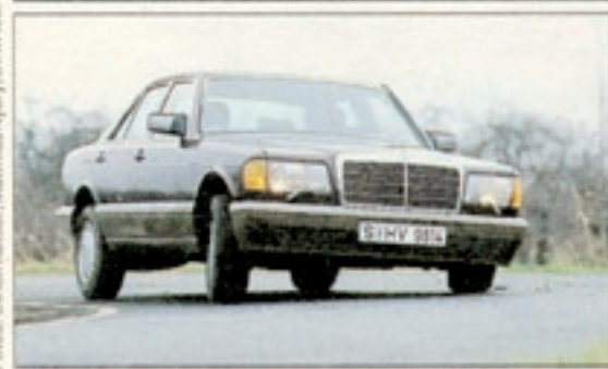
Zügiges Kurvenfahren macht mit dem Mercedes kein Vergnügen – der Aufbau wankt zu stark
