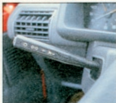
Der Blinkerhebel des Franzosen hat viele Aufgaben: zweimal drehen, und das Licht geht an; einmal drücken, und es hupt
