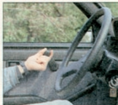
Die weit oben montierte Fensterkurbel ermöglicht vollgepackte Türablagen, ohne daß man ständig dagegenstößt
