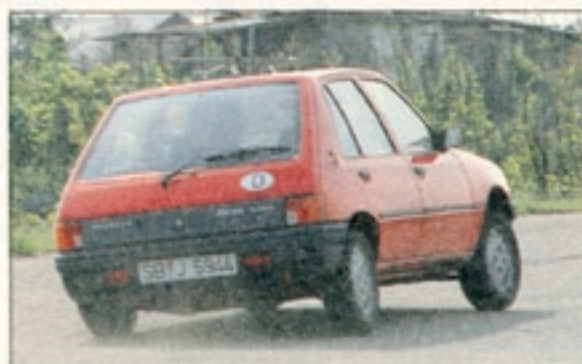
In schnellen Kurven geht der kleine Peugeot 205 ziemlich stark in die Knie. Er ist für verhaltene Fahrweisen und mehr auf Komfort ausgelegt. Dennoch bleibt er auch in brenzlichen Situationen gutmütig und jederzeit leicht beherrschbar
