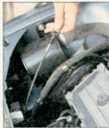
Vorne unten links sitzt der Ölpeilstab. Erfreulich: Er ist so angebracht, daß die Finger beim Herausziehen sauber bleiben
