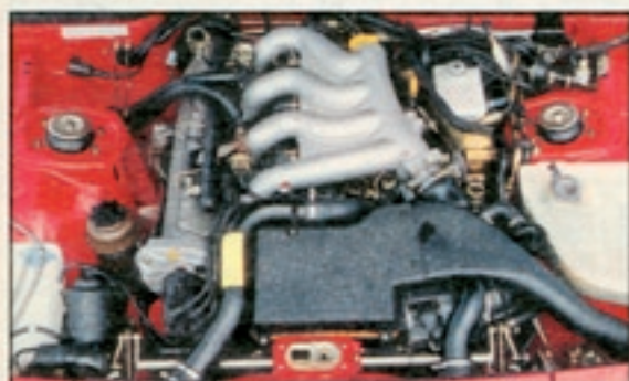
Das Kraftpaket von Porsche: vier Zylinder, Turbolader, 220 PS. Ärgerlich: Der Ölnachfüllstutzen sitzt versteckt hinterm Motor
