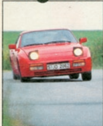
Kurven nimmt der Porsche neutral durch seine Transaxle-Bauweise. Das heißt: Motor vorne, Getriebe hinten
