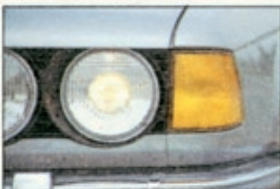
Ganz neu: Ellipsoidscheinwerfer. Sieht aus, als hätte der BMW eine Pupille. Effekt: neuartige, optimale Ausleuchtung der Fahrbahn
