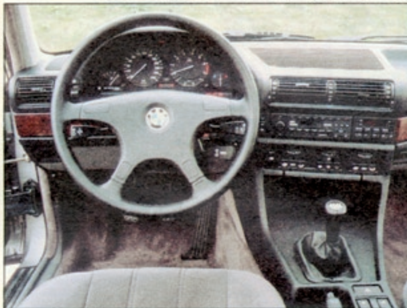
Tradition fortgesetzt: vorbildliches Cockpit mit klaren Instrumenten, Check-Control und Bordcomputer. Klimaanlage wird vollelektronisch geregelt. Ein Novum: An jeder Frischluft-Walze kann die Temperatur separat geregelt werden. Vorteil: kein eiskaltes Anblasen
