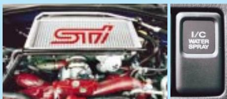
Mit allen Wassern gewaschen: Aus 2,5 Litern holt der Turbo-Boxer 280 PS. Dank zuschaltbarer Wasserspülung des Ladeluftkühlers kurzfristig auch etwas mehr
