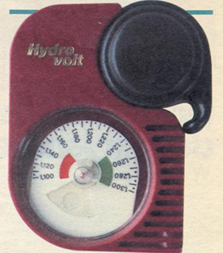
Oben rechts die Pumpe zum Ansaugen der Säure. Auf der übersichtlichen Skala fällt das Ablesen leicht
