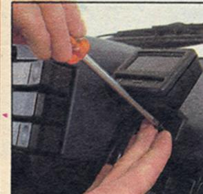
Jetzt können Sie das Thermometer anschrauben, das Kabel durch das große Loch ziehen
