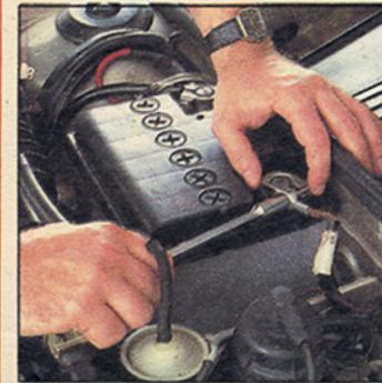
Bevor Sie mit dem Einbau beginnen: Minuspol der Batterie abklemmen. Wichtig bei allen Arbeiten an der elektrischen Anlage, sonst gibt's einen Kurzschluss
