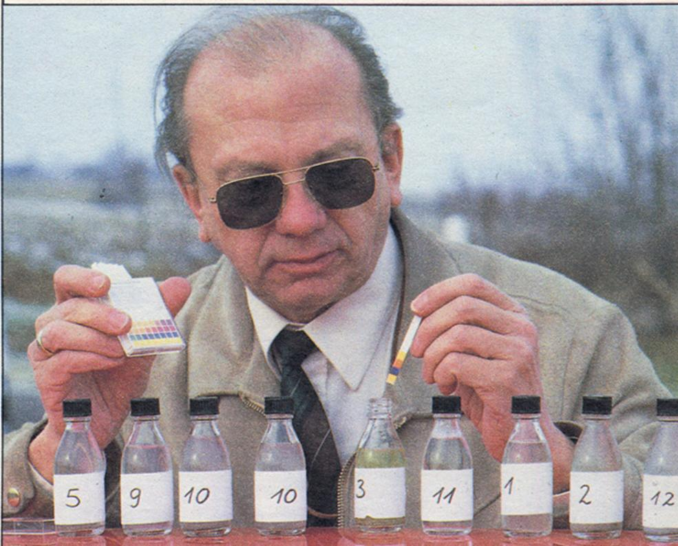
Mit diesen pH-Indikator-Stäbchen wurden gleich nach der Wasserentnahme erste Testproben gemacht. Richtig gelb wurde zum Glück kein Stäbchen. Das hätte bedeutet: Sehr sauer und äußerst salzig. Schnalke: „Ein wichtiger Test direkt an der Waschstraße“
