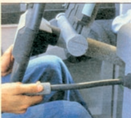
Von Fahrern jeder Länge bequem zu bedienen: Schaltstange statt Schaltknüppel
