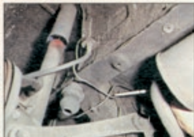
Die Radaufhängungen neigen zu frühzeitigem Verschleiß. Kosten bis 500 Mark
