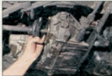
Ritmo-Antriebseinheiten verlieren gerne Öl. Kosten bis 250 Mark
