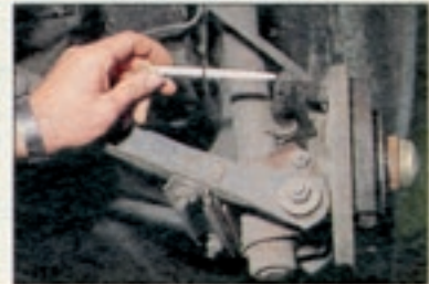
Ritmo-Bremsanlagen verzögern oft ungleichmäßig. Kosten bis 600 Mark
