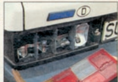
Ritmo-Rücklichter leiden hin und wieder unter Stromausfall. Pro Seite 200 Mark
