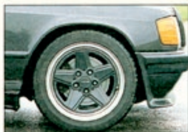
Auch AMG montiert Felgen im 7,5-Zoll-Format, auf denen Reifen der Dimension 205/50 VR 16 Platz finden
