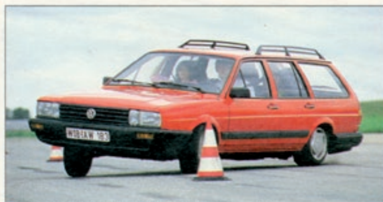
Vollbeladen mit 480 Kilogramm, ist der Passat im Grenzbereich mit Vorsicht zu genießen. Er bricht dann leicht hinten aus
