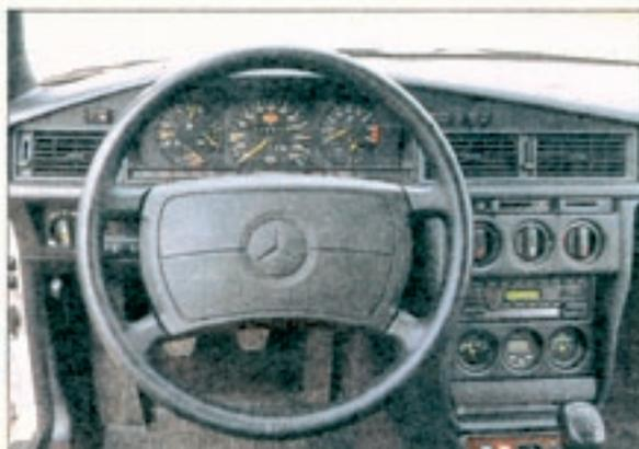
Für den gewissen Unterschied zwischen dem Sechzehventiler und den bürgerlichen kleinen 190-Typen sorgt die Mittelkonsole mit Othermometer, Stoppuhr und Voltmeter
