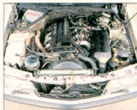
Auch bei geöffneter Motorhaube demonstriert der Sechzehventiler Sportlichkeit. Ein verrippter Ventildeckel in schwarzem Schrupplack mit polierter Aufschrift zeigt dem Liebhaberauge, daß darunter moderne Mehrventil-technik steckt. Alle wichtigen Aggregate sind für Mechanikerhände gut erreichbar
