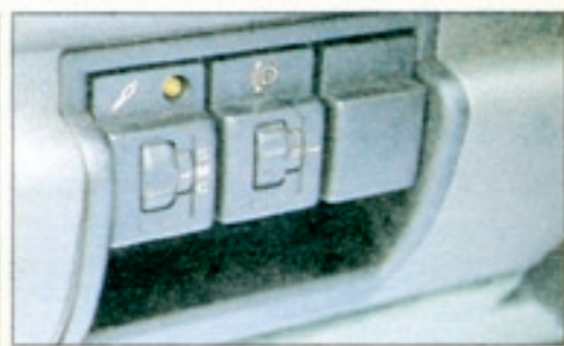
Oben: Mit den linken Rädchen wird die Fahrwerkschärfe reguliert. Links: Die Opel-Automatik hat drei Programme: Sport, Spar und Schnee
