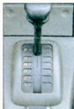
Oben: Mit den linken Rädchen wird die Fahrwerkschärfe reguliert. Links: Die Opel-Automatik hat drei Programme: Sport, Spar und Schnee
