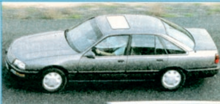
Der Kat-Senator hat zunächst 156 PS. Ab nächstem Frühjahr gibt's 177 saubere PS – mit dem gleichen Motor
