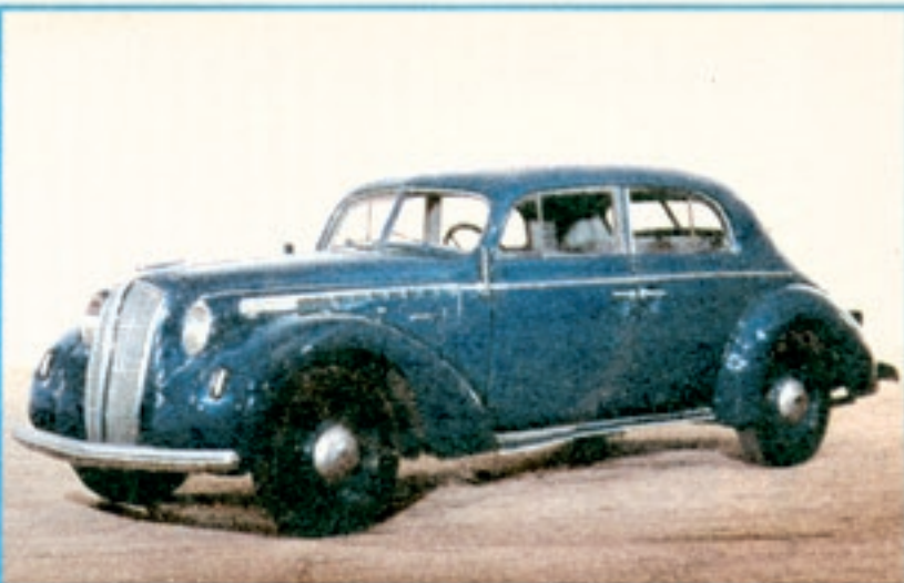
1937: Luxuslimousine zum 75jährigen Geburtstag. Der Opel Admiral setzt Maßstäbe: 3,6-Liter-Sechszylindermotor mit hängenden Ventilen, üppigem Platz für Passagiere und Gepäck zu einem für die Oberklasse günstigen Preis: 6500 Mark
