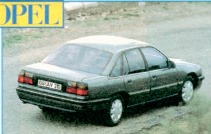
1987: Das jüngste Produkt aus Rüsselsheim, der neue Senator. Moderne Karosserie mit außen plan anliegenden Scheiben. Rings um die Heckscheibe ist eine kleine Regenrinne eingelassen; sie soll Wasserwirbel fernhalten
