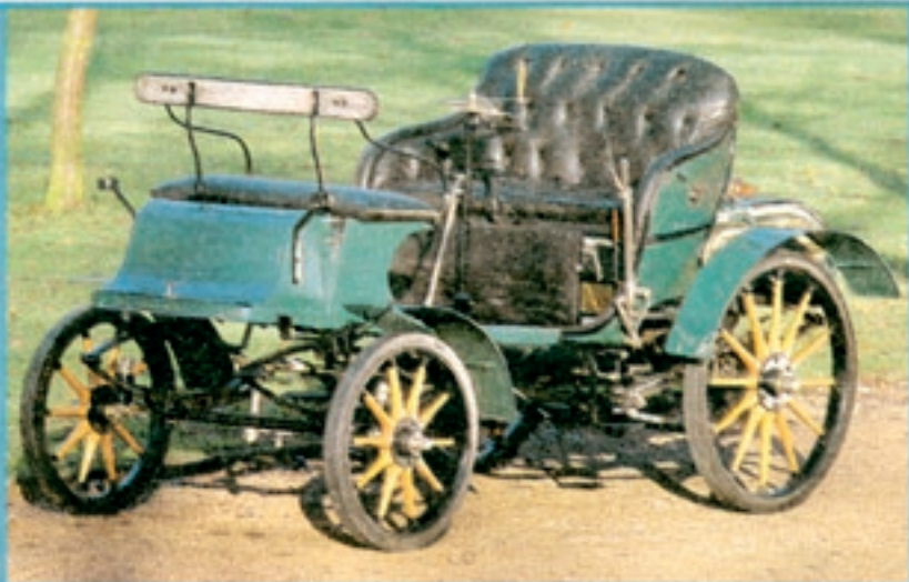
1899: Das Erstlingswerk, der Opel-Patent-Motorwagen, System Lutzmann. Der Einzylindermotor (1545 ccm Hubraum) leistet 3,5 PS. Höchstgeschwindigkeit: 20 km/h, Verbrauch: 10 Liter Benzin auf 100 km – erhältlich nur in Apotheken
