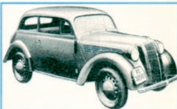
1936: Der Ur-Typ des Millionenautos Kadett. Erstmals erhält ein Billig-Auto (2100 Mark) eine selbsttragende Karosserie – dazu den 23-PS-Vierzylinder des P 4
