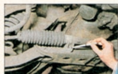
Großes Lenkspiel: Die Staubmanschetten des Manta-Lenkgetriebes reißen gern. Wird es nicht bemerkt, geht die Lenkung im Nu kaputt. Kosten ca. 450 Mark
