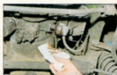
Ölverlust an der Benzinpumpe: Manta-Motoren kleckern hin und wieder an der Benzinpumpe. Werfen Sie einen Blick unter den Motor. Kosten: 100 Mark
