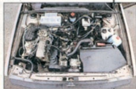
Aus fünf Zylindern und 2,3 Liter Hubraum holt der Passat 120 Kat-PS. Er hat zwei Ventile pro Zylinder
