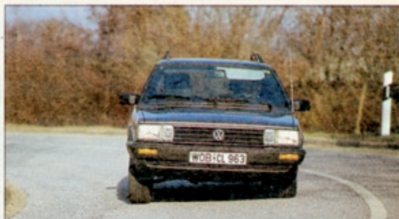
Höhere Kurvengeschwindigkeiten erreicht der VW Passat Variant, ohne auszubrechen. Ist der Fahrer zu schnell, drängt die Fliehkraft den Allradler breitwärts nach außen
