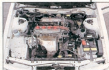
Der Zweilitermotor des Camry leistet mit viel Elektronik und 16-Ventil-Technik 121 PS – trotz Katalysator
