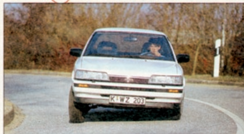
Der frontgetriebene Toyota Camry schiebt in scharf gefahrenen Kurven mit den Vorderrädern nach außen. Er muß mit stärkerem Lenkeinschlag auf Kurs gehalten werden
