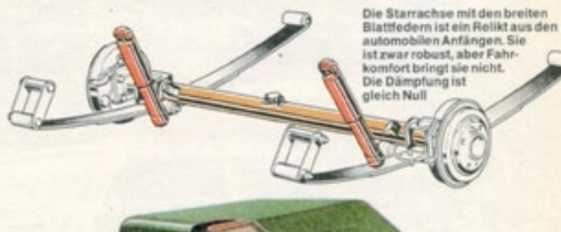
Die Starrachse mit den breiten Blattfedern ist ein Relikt aus den automobilen Anfängen. Sie ist zwar robust, aber Fahrkomfort bringt sie nicht. Die Dämpfung ist gleich Null
