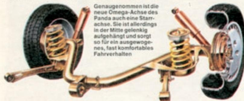
Genau genommen ist die neue Omega-Achse des Panda auch eine Starrachse. Sie ist allerdings in der Mitte gelenkig aufgehängt und sorgt so für ein ausgewogenes, fast komfortables Fahrverhalten
