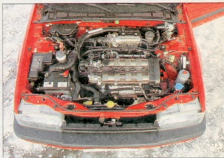
Der 16-Ventil-Motor im Honda ist quer eingebaut. Er ist bereits aus dem Honda Prelude bekannt. Seine großen Stärken: gutes Ansprechen auf Befehle vom Gaspedal und ein enormes Drehvermögen. Ohne besonders angestrengt zu wirken, schafft er locker 7000/min.
