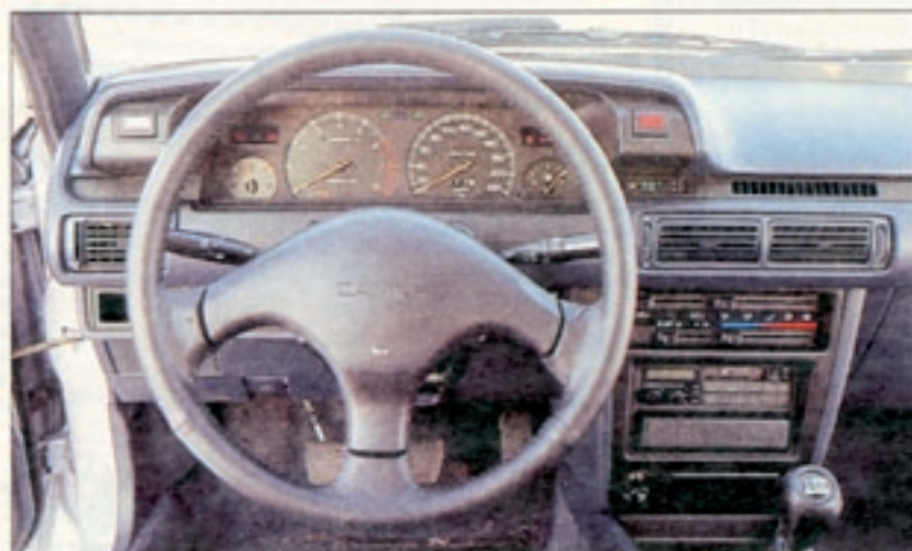
Geschickte Imitation: Das Toyota-Lenkrad sieht nur so aus, als wäre es aus Leder. Es läßt sich in der Höhe verstellen. Der Drehzahlmesser reicht bis 8000/min. Das ist übertrieben, denn mehr als 6400/min erlaubt der Drehzahlbegrenzer dem Motor nicht
