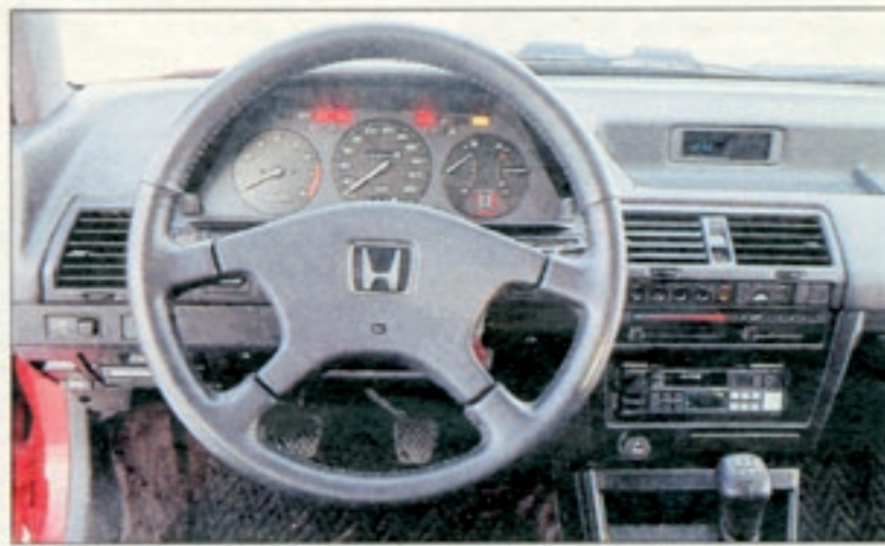
Auch das Honda-Lenkrad läßt sich in der Höhe verstellen. Der Lenkradkranz ist mit griffsympathischem Leder bezogen. Gut: viele Fächer für Kleinkram. Wenig praxisgerecht: die Verteilung der Heizluft über Tasten in der Mittelkonsole. Da muß man schon genau hinschauen, die Aufmerksamkeit vom Straßenverkehr abwenden
