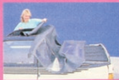
... jetzt wird das Verdeck vorne am Windschutzscheiben-Rahmen entriegelt und über die oberen Türrahmensegezogen
