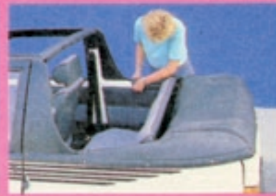
Nun verschwindet die zusammengelegte Haube unter einer Persenning. Nochmal 15 Druckknöpfe und der Spaß kann beginnen!
