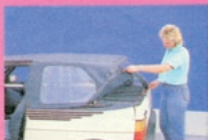
Das Öffnen der handgenähten Kapuze erfordert viel Übung und eine Menge Kraft. Zuerst werden die hinteren Druckknöpfe gelöst . . .
