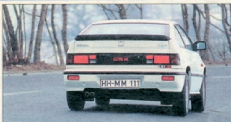
In schnellen Kurven wird aus harmlosem Untersteuern (schieben über die Vorderachse) plötzlich Übersteuern (das Heck schwenkt nach außen)
