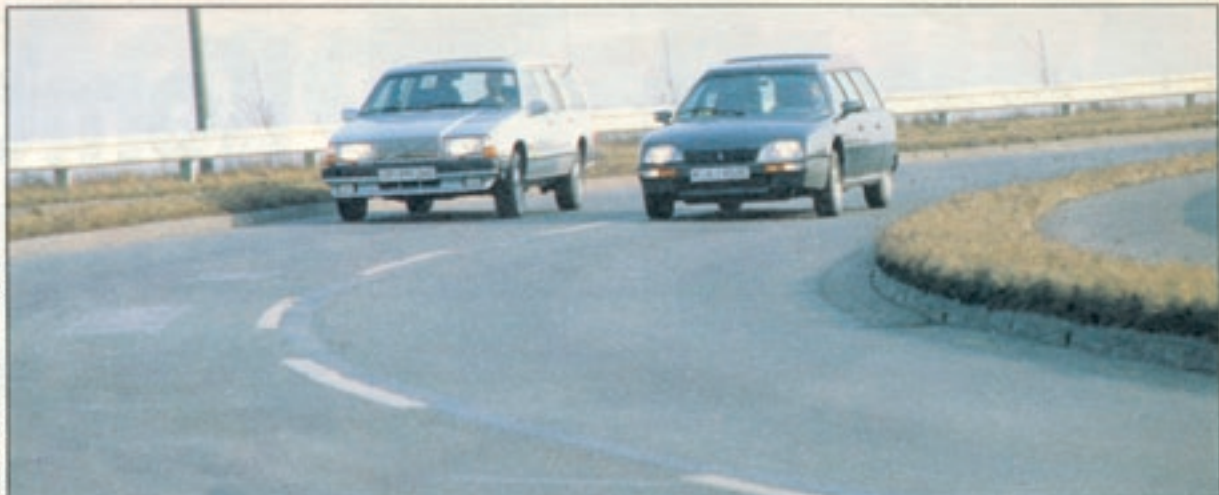
Leer hat der Volvo (links) ein neutrales Fahrverhalten. Das ändert sich, wenn er beladen wird. Dann bricht er schnell mit dem Heck aus. Der Citroën (rechts) ist leer wie voll leicht zu beherrschen. In schnell gefahrenen Kurven schiebt er über die Vorderräder
