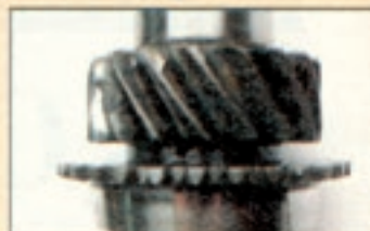
Ein Zahn ist schon halb ausgebrochen, alle Zahnflanken sind zerklüftet und abgewetzt. Das läßt auf minderwertiges Material schließen
