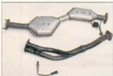
Bei 63 070 km wurde der Katalysator erneuert. Das Hosenrohr und die Lambdasonde (unten) wurden bei 79 720 km ausgewechselt
