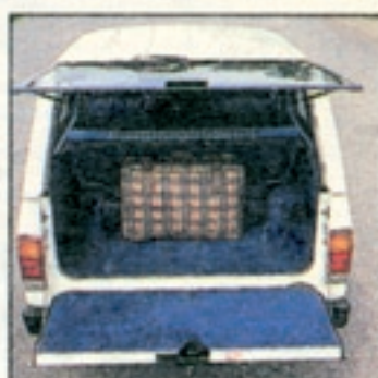
Der Heckaufbau des Nissan Patrol ist ein Hardtop und läßt sich abnehmen
