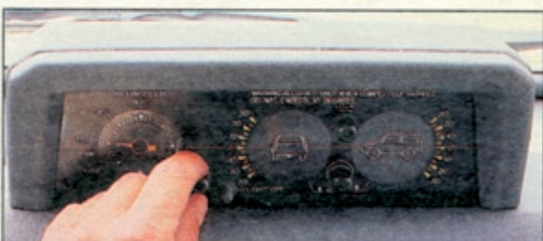
Profi-Zubehör im Toyota Land Cruiser: links ein Altimeter (Höhenmeßgerät). Mitte und rechts: Neigungswinkel-Anzeigen. Fürs wirklich schwere Gelände unentbehrlich
