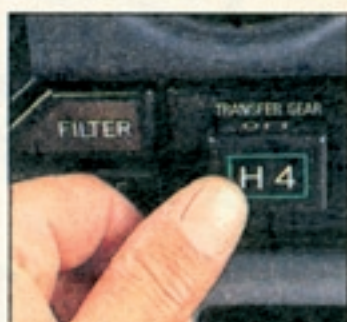
Lediglich beim Toyota Land Cruiser läßt sich der Allradantrieb während der Fahrt (bis 50 km/h) auf Knopfdruck zuschalten. Dabei gibt's allerdings sehr laute mechanische Geräusche
