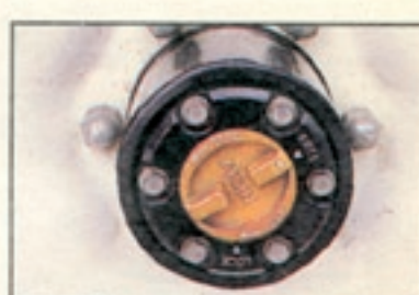
Der Daihatsu und der Toyota haben mechanische Freilaufnaben. Zum Ver- und Entriegeln muß ausgetrieben werden
