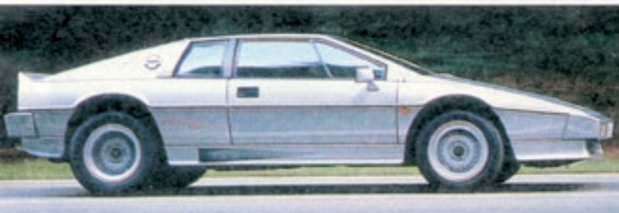
Die keilförmige Kunststoffkarosserie des Lotus sitzt auf einem Gitterrohrrahmen
