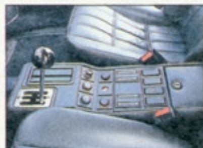
Der Schalthebel wird beim Ferrari traditionell in einer Kullase geführt
