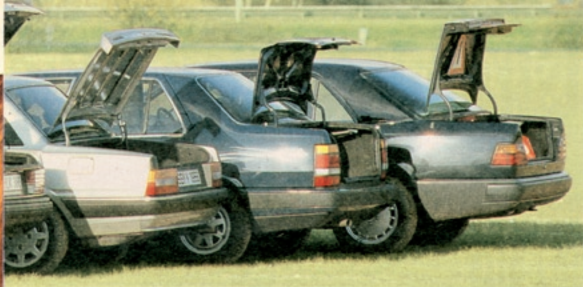
hohe Ladekanten. Die Kofferraumdeckel vom Lancia Thema 6V und Mercedes 260 E reichen hinunter bis zur Stoßstange (von links)
