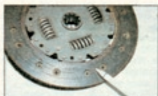
Der Kupplungsbelag reißt an den Niet-Stellen ein. Ein Zeichen für starke Beanspruchung
