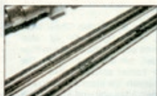
Eine der wenigen Schwachstellen: die Kipphebelwellen zeigen Einlaufspuren, Riefen
