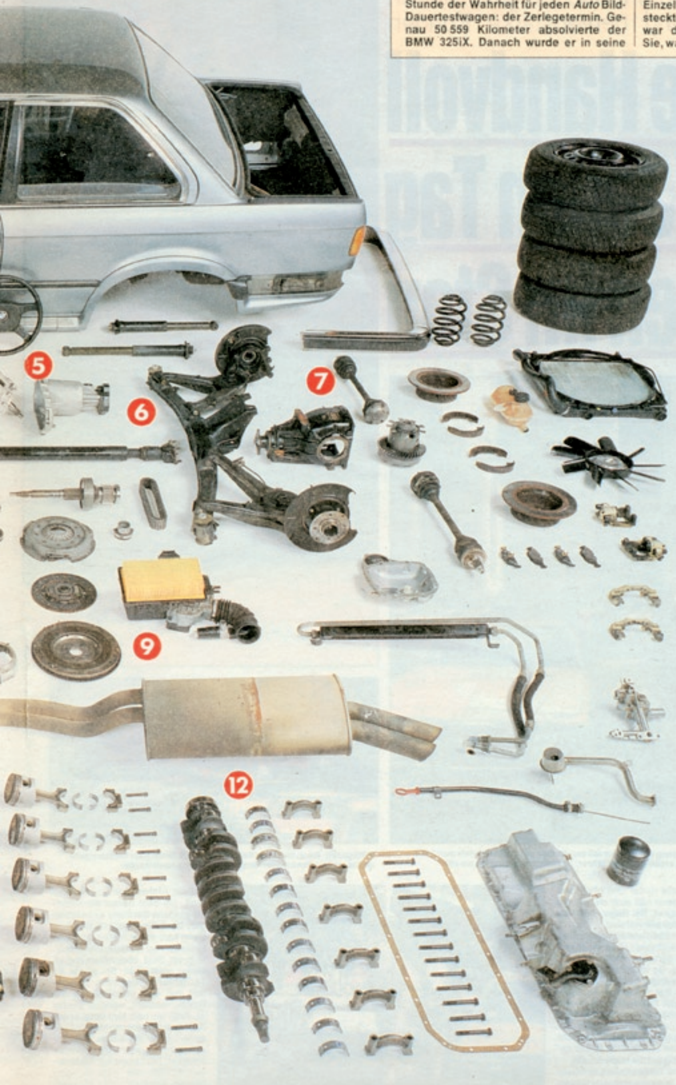
Hundertstelmillimetergenau überprüft Kfz-Meister Wolf Gudlat (47) alle Einzelteile des zerlegten BMW
