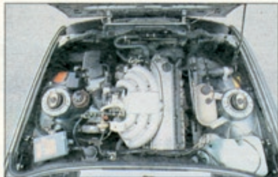
Im Reihensechszylinder mit elektronischer Benzineinspritzung fanden sich selbst nach 50 000 Kilometern keine nennenswert abgenutzten Verschleißteile
