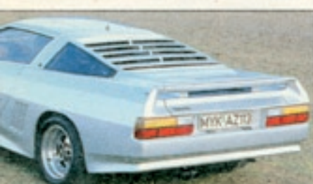
höht den Anpreßdruck an der Hinterachse. Dafür wird Rückwärtsfahren zum Blindekuhspiel
