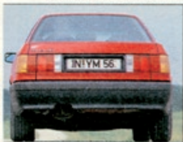
Neue Heckansicht: Die Schriftzüge verraten nur den Motor, nicht mehr das Ausstattungspaket. Ein Teil der Heckleuchten ist auf den Kofferdeckel montiert
