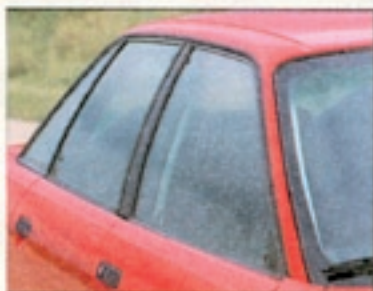
Beim kleinsten Audi liegen die Scheiben bündig auf der Karosserie. Spezielle Gummiprofile verhindern, daß beim Türöffnen Regenwasser in den Wagen rinnt
