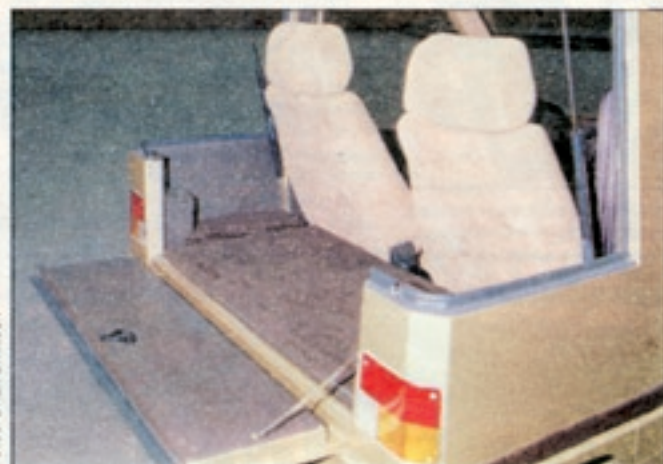
Wie eine Düsenjäger-Kanzelläuft sich die Heckveranda aus Plexiglas zum Beladen hochklappen. Eine zusätzliche Klappe zwischen den Heckleuchten senkt die Ladehöhe bis auf den Wagenboden. Der Stauraum ist erheblich. Hier zählt die Höhe und nicht die Tiefe
