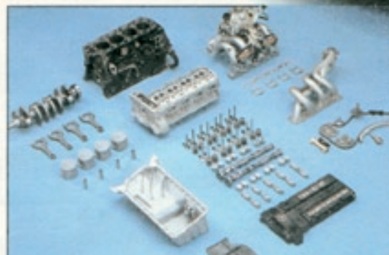
Mercedes-Motor zerlegt (oben): Zylinderkopf mit 16 Ventilen, Tassenstößel-Ventilsteuerung, Nockenwellen-Antrieb durch Einfach-Rollenkette. BMW-Motor (unten): Der Leichtmetall-Vierventilmotor stammt vom M1. Tassenstößel-Ventilsteuerung und...
