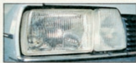
In die Hauptscheinwerfer des Wolfsburgers tritt gerne Feuchtigkeit ein und läßt die Reflektoren ermaten. Neue Lampen sind nicht billig: ca. 460 Mark
