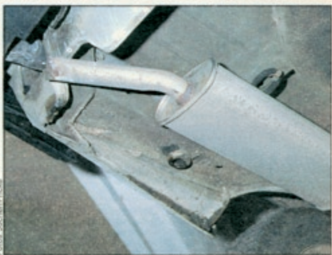
In der Auspuffanlage nistet sich beim VW Passat der Rostteufel besonders gern ein. Vor allem der Endschalldämpfer ist davon betroffen (ca. 110 Mark). Erheblich teurer wird die Reparatur, muß die Anlage von vorn bis hinten erneuert werden. Kosten: ca. 570 Mark
