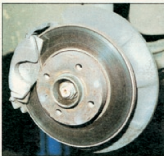
Die vordere Bremsanlage ist dem aufreibenden Dienst im VW Passat nicht sonderlich gewachsen. Brems-scheiben und Bremsklötze müssen überdurchschnittlich früh erneuert werden. Die Kosten für eine Reparatur sind mit ca. 280 Mark zu veranschlagen
