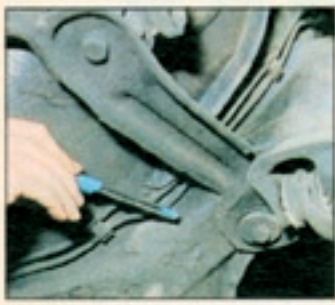
Rost im Unterbodenbereich: Die vorderen Hilfsrahmen haben zu allem Übel genau an der Stelle ihren Schwachpunkt, an der die Vorderachse befestigt ist. Meist lohnt eine Reparatur nicht
