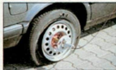
Normalreifen bei plötzlichem Druckverlust: Er rutscht von der Felge
