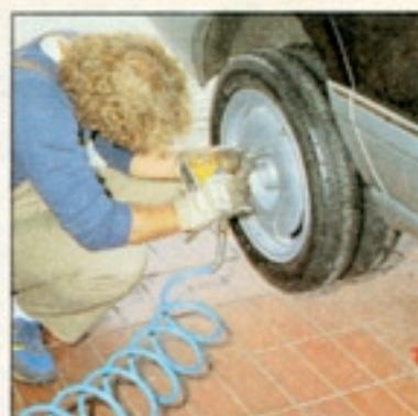
Ungewohnter Anblick: die Zwillingsschrauben unter dem Mercedes 300 SE. Für die Montage der Räder sind spezielle Schrauben notwendig
