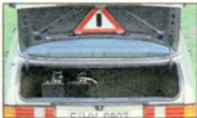
Größer: Der Mercedes-Kofferraum schluckt eine Kleinigkeit mehr (505 Liter). Dafür müssen die Ski in jedem Fall aufs Dach
