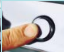
Der Kofferraum wird mittels eines klassischen Druckknopfs elektrisch entriegelt. Eine Fernbedienung ist nicht erhältlich
