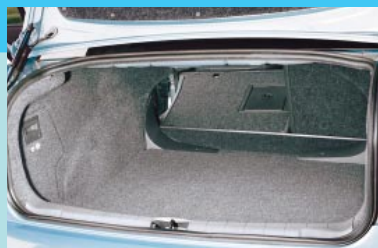
Glatte Seitenwände und außen liegende Scharniere sorgen für gute Nutzbarkeit. Die Ladekante ist nur 70 Zentimeter hoch
