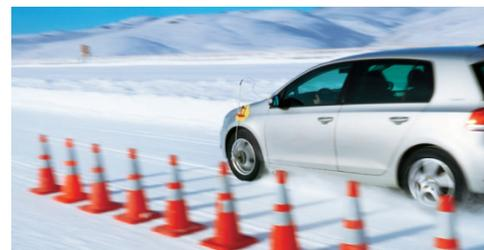
Nur bei der Traktionsmessung kann sich der reine Winterreifen noch von den kräftig zupackenden Ganzjahresreifen absetzen. Apollos Alnac 4G neigt trotz Schneeflockensymbol auf der Reifenflanke an Steigungen zum Durchdrehen der Vorderräder.
